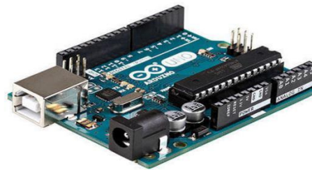
Fig. Arduino Uno
