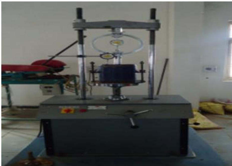
**Figure C.B.R test apparatus**
