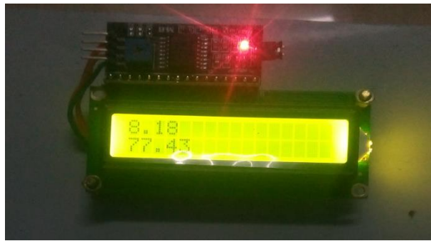
Fig. 4.4 LCD Display for Latitude and Longitude reading
